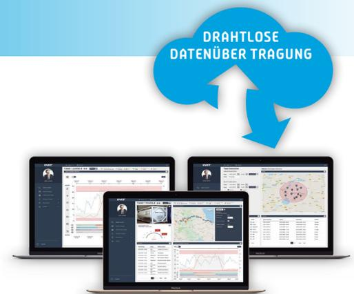
Die Temperaturwerte werden in der IMT-Webanwendung angezeigt und können über die offene und kostenlose IMT-API-Schnittstelle abgerufen werden. So lassen sich die Messwerte sehr einfach in jedes bereits vorhandene TMS (Transportmanagementsystem) integrieren. Bei Statusänderungen (z.B. bei Über- oder Unterschreiten von Temperaturschwellen) erhält der Nutzer der IMT-Plattform automatisch eine Alarmbenachrichtigung.
